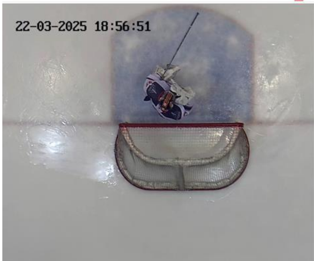
Рис.3. Изображение с камеры над воротами – неправильное расположение (не захватывает лицевой борт и круги вбрасывания)
